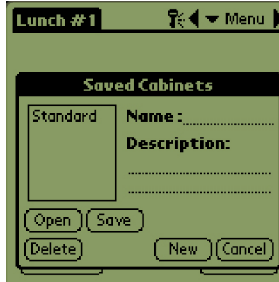
Adım 2: i ikonuna dokunulduğunda Kayıtlı Kabinler iletişim kutusu açılır. İlgili düğmelerle ilgili açıklamalar aşağıdadır.
